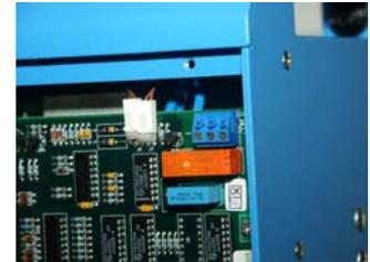
Das Potential-Relais befindet sich links-oben auf der Leiterplatte
